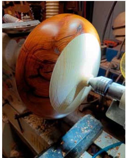
Het essenhouten deksel en de buitenvorm in één vloeiende beweging vorm geven.
